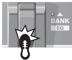
Gebruik in de Handmatige modus en de Geheugenbewerkingmodus het pedaal [BANK ▲]/[EQ] om in en uit te schakelen.
