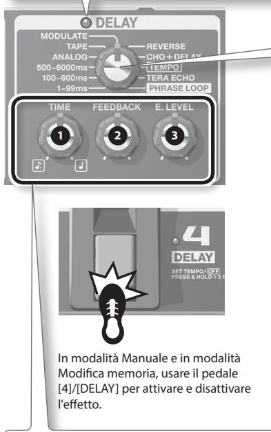
In modalità Manuale e in modalità Modifica memoria, usare il pedale [4]/[DELAY] per attivare e disattivare l'effetto.
