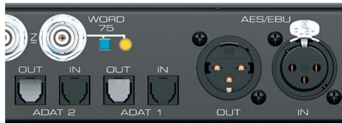
**ADAT2 I/O.** TOSLINK. Standard ADAT optical Port, 8 Kanäle. Kann nach Umschaltung im Settingsdialog auch als optischer SPDIF Ein- und Ausgang genutzt werden.
