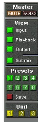
Statt einzelner Presets kann auch eine komplette Preset-Bank, also alle 8 Presets auf einen Schlag geladen werden. Vorteil: Die den Presetknöpfen zugewiesenen Namen werden mit abgespeichert und geladen.
