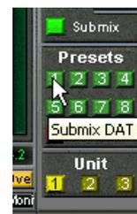
**Tastatur:** Mit Strg und der entsprechenden Zahl (**1 bis 8, nicht Nummernblock!**) werden die Werks-Presets per Tastatur geladen. Mit der Alt-Taste werden die User-Presets geladen.
